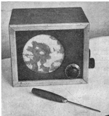
Nur 170×140×120 mm ist dieser Allstromempfänger groß. Diese beiden Bilder legen im Vergleich zu Schraubenzieher und Röhrenpackung überzeugend die wirklich kleinen Abmessungen dar.
